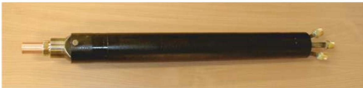
**Назначение резака:** машинная разделительная резка низкоуглеродистых сталей толщиной от 300 до 1200 мм (поковки, слитки, отрезка прибылей и т.п.). Внедрен и успешно эксплуатируется на Краматорском заводе “Энергомашспецсталь”.
