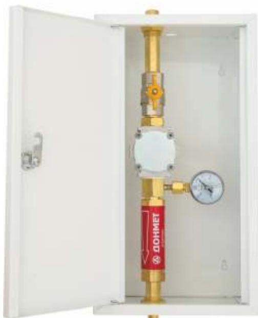
Пост газоразборный горючего газа ПГА-15-3ДМ устанавливается на газопровод в месте проведения газопламенных работ и предназначен для питания газопламенной аппаратуры горючим газом, контроля давления подаваемого газа, защиты газопроводов от обратных ударов пламени, а также от проникновения в них кислорода и воздуха со стороны потребления.
