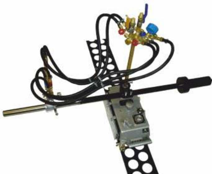
**Предназначен для** непрерывной резки заготовок квадратной и прямоугольной формы из низкоуглеродистых сталей.
