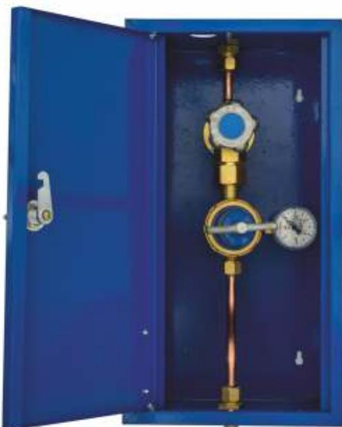
Пост газоразборный кислорода ПГК-10-3ДМ устанавливается на кислородопровод в месте проведения газопламенных работ и предназначен для понижения давления, поступающего на пост кислорода и подачи его к месту потребления для питания газопламенной аппаратуры кислородом.
