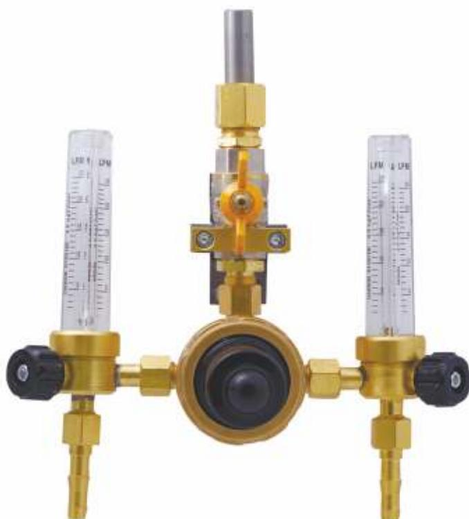
Пост газоразборный Аргон / CO<sub>2</sub> ПГ АР/СО2-25-3,5 ДМ предназначен для понижения давления, поступающего на пост аргона, углекислого газа или их смеси и подачи его к месту потребления для питания сварочного оборудования.
