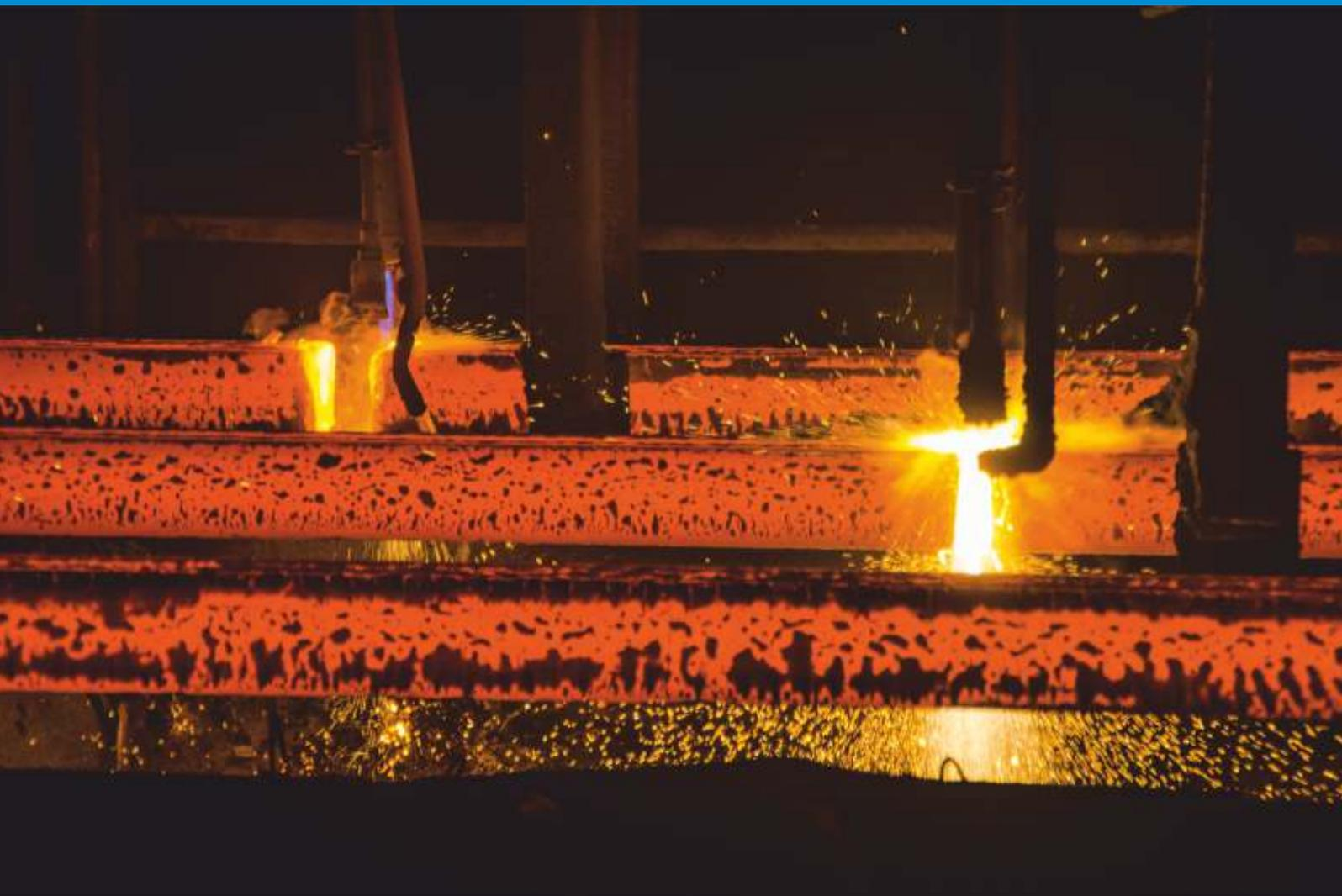
Уникальные машинные резаки повышенной мощности предназначены для разделительной резки низкоуглеродистых сталей больших толщин. Особенностью данных резаков является повышенная безопасность при резке металла. Это достигается путем применения конструкций резаков с внутрисопловым и внешнесопловым смешением газов. Резаки, предназначенные для работы на линиях МНЛЗ имеют водяное охлаждение, что позволяет им работать длительное время при экстремально высоких температурах окружающей среды.
