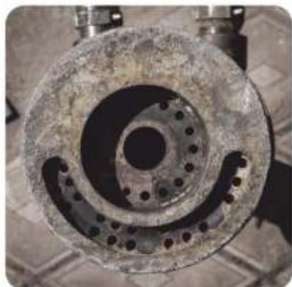
Газокислородная горелка «ДОНМЕТ» 292 (ГКГ) используется в начальный период плавления металлошихты вместе с энергией дугового нагрева, вводимой на максимальной ступени мощности трансформатора.
