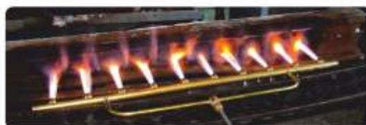
Горелка линейная ГЛ «ДОММЕТ» 271-32 , предназначена для ручного пропано-кислородного нагрева деталей перед дальнейшей обработкой (сварка, наплавка, пайка и пр.).
