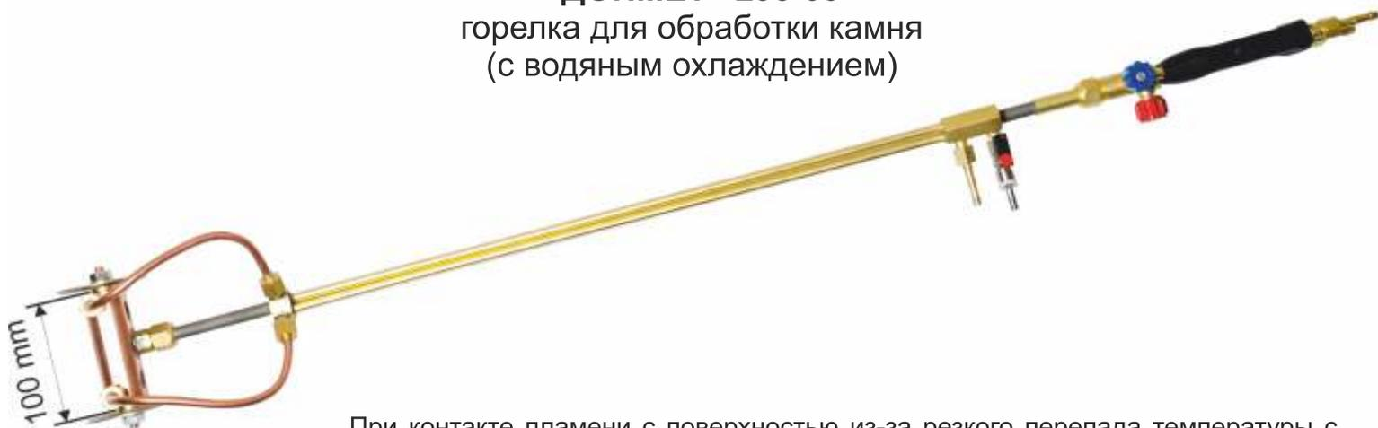
При контакте пламени с поверхностью из-за резкого перепада температуры с внешнего слоя гранита вылетают неустойчивые минеральные зерна, и таким образом создается рельефная шероховатая поверхность.
