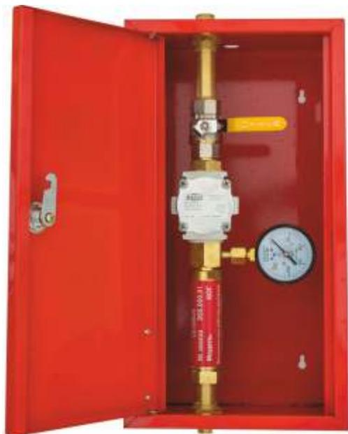
Пост газоразборный горючего газа ПГУ-25-3ДМ устанавливается на газопровод в месте проведения газопламенных работ и предназначен для питания газопламенной аппаратуры горючим газом, контроля давления подаваемого газа, защиты газопроводов от обратных ударов пламени, а также от проникновения в них кислорода и воздуха со стороны потребления.
