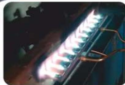
Горелка линейная "ДОММЕТ" 219 А предназначена для ручного ацетилено – кислородного нагрева деталей перед дальнейшей обработкой (сварка, наплавка, пайка и др.).
