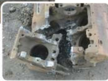
Образец реза блока цилиндров
