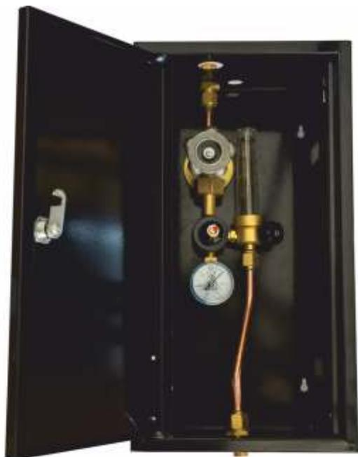
Пост газоразборный Аргон / CO<sub>2</sub> ПГ АР/СО2-25-3 ДМ предназначен для понижения давления, поступающего на пост аргона, углекислого газа или их смеси и подачи его к месту потребления для питания сварочного оборудования.
